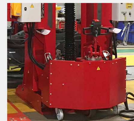
SISTEMA DI MOVIMENTAZIONE MOTORIZZATO A BATTERIE Motorized displacement system: battery operated
