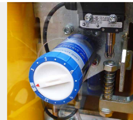
SISTEMA DI LUBRIFICAZIONE AUTOMATICO Automatic lubrication system
